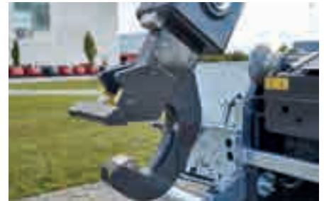
Geschmiedeter, einfach auswechselbarer Aufnahmehaken
