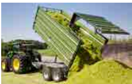
Silierkipper mit hydraulischer Rückwand
