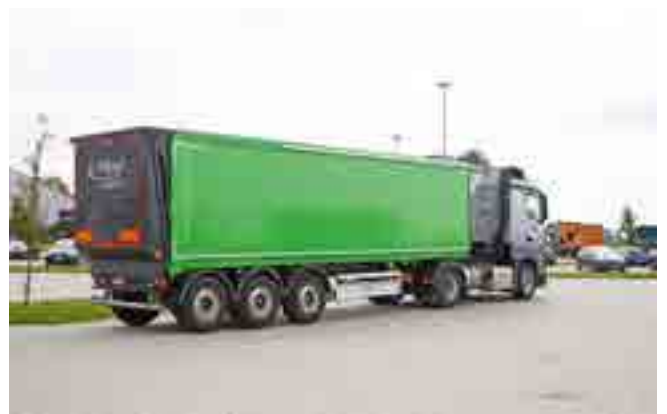
ASS 398 GREEN-TEC mit Seitenwände aus Aluminium
