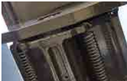
Automatische Hakenverriegelung beim Kippvorgang
