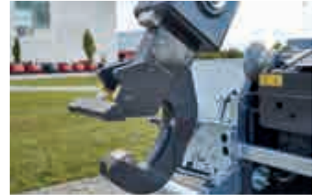
Geschmiedeter, einfach auswechselbarer Aufnahmehaken
