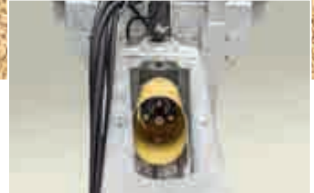
Über einen Zapfwellendurchtrieb wird das Streuwerk mech. angetrieben
