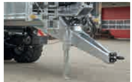
Zugholm ungefedert, drehbar für Oben- und Untenanhängung
