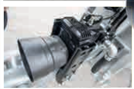
Bordhydraulik für max. Leistung unabhängig vom Zugfahrzeug
