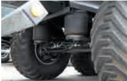
Optional: Luftfederung mit automatischer Kippabsenkung
