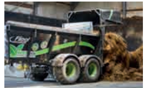
Der ADS ist optional mit Großraumrückwand 800mm umrüstbar und als Transportanhänger nutzbar
