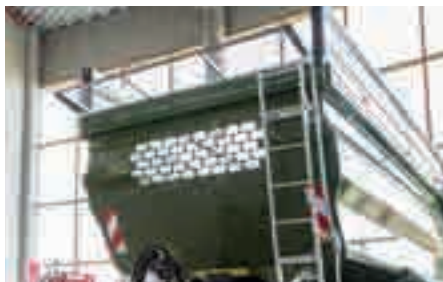
Mechanisch klappbares Schutzgitter
