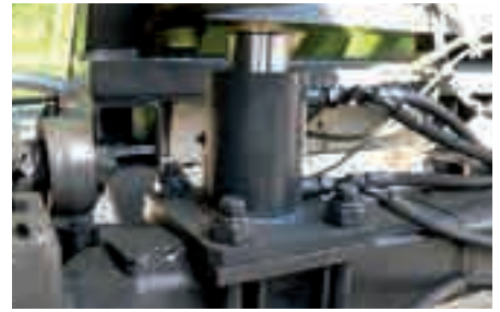
Optional: Hydraulische Abstützung auf die Achse
