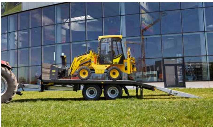
Pratique : décalage possible des segments pour adapter la largeur de voie des rampes
