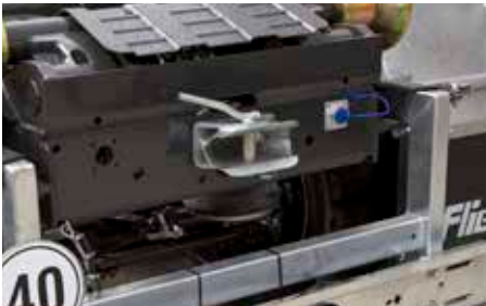
En option : support d'éclairage escamotable, raccordement pour frein et hydraulique pour la 2ème remorque
