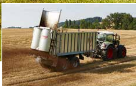
Mécanisme d'épandage PROFI V2 avec disque d'éjection et balancier
