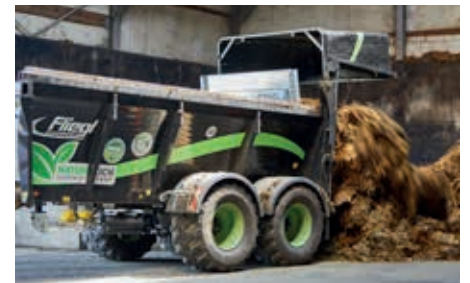
L'ADS peut être équipé en option d'une large paroi arrière de 800 mm et peut être utilisé comme remorque de transport
