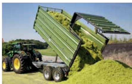
Benne d'ensilage avec paroi arrière hydraulique
