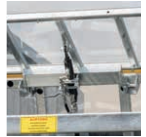
Grille frontale rabattable mécanique de série ou hydraulique en option.
