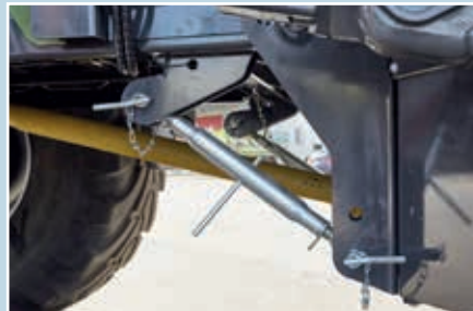
Chaîne cinématique des hérissons horizontaux. Limiteur de charge par embrayage à came dans l'arbre de transmission au tracteur.
