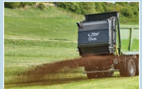
L'épandeur large à disque varioSPLASH permet des largeurs d'épandage allant jusqu'à 32 m.
