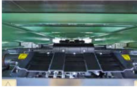
Système de verrouillage commutable pour verrouillage intérieur et extérieur
