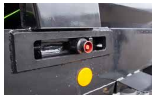
Pignons facilement accessibles et lubrifiables par l'arbre des deux côtés
