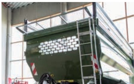
Grille de protection rabattable mécaniquement
