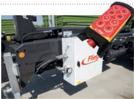
Commande avec commande à distance (en option)
