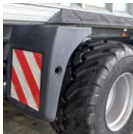
Gardes boues latéraux, ailes enveloppantes et tôle arrière en plastique à finitions spéciales assurant une propreté de la caisse, de la route et sécurisant l'Homme et la machine.
