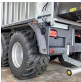
Gardes boues latéraux, ailes enveloppantes et tôle arrière en plastique à finitions spéciales assurant une propreté de la caisse, de la route et sécurisant l'Homme et la machine.
