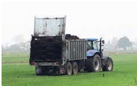
Épandeur « Profi V2n » Pour remorque à fond poussant avec une hauteur de benne de 1500 mm
