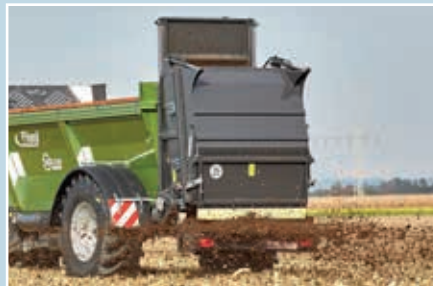
L'épandeur large à disque varioSPLASH permet des largeurs d'épandage allant jusqu'à 32 m.
