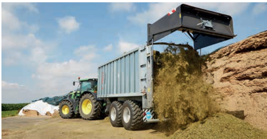
Rouleau de dosage avec 3 rouleaux fraiseurs horizontaux
