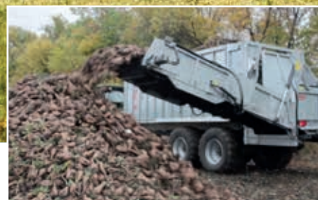
Tapis de transbordement RUBY pour betteraves sucrières Capacité de transbordement env. : 15 m 3 /min
