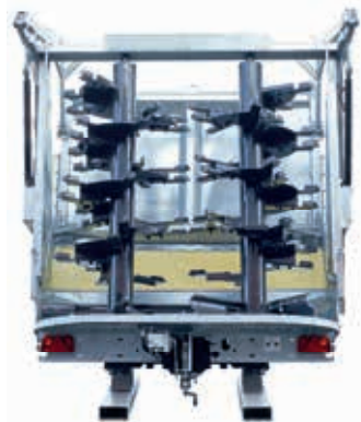
Rouleaux fraiseurs avec pales d'éjection
