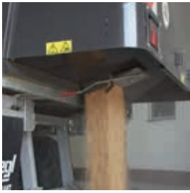
Large paroi arrière avec trappe à céréales de série
