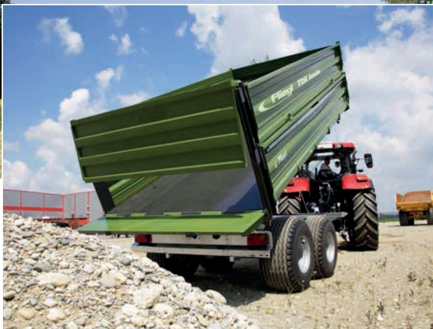
TDK 160 avec volet hydr. pour gravier 500 mm Pont : 5000 x 2320 x 2220 mm
