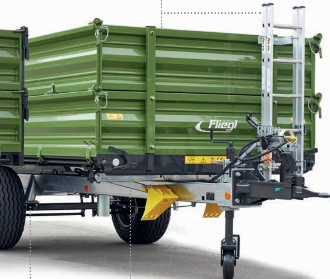
En option : Module 500 mm avec échelle
