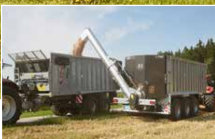
Vis de transbordement ÜLS 400 pour céréales. Capacité de transbordement d'env. 7,5 t/min
