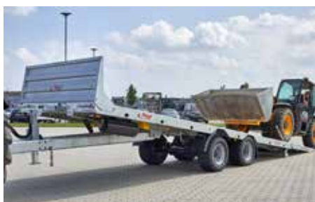
Ab TPA 200: Hydraulisch kippbare Deichsel
