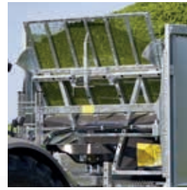
Système à fond poussant „Insight“ grande surface transparente en ma-tériaux résistant aux chocs pour une meilleure visibilité
