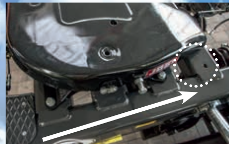
Réglage mécanique de la sellette d'attelage pour dolly simple essieu et tandem
