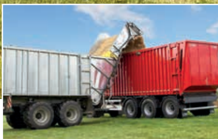
Tapis de transbordement « MobilFast » (jusqu'à 30 m 3 /min)
