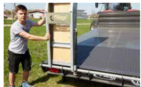
Pratique : décalage possible des segments pour adapter la largeur de voie des rampes
