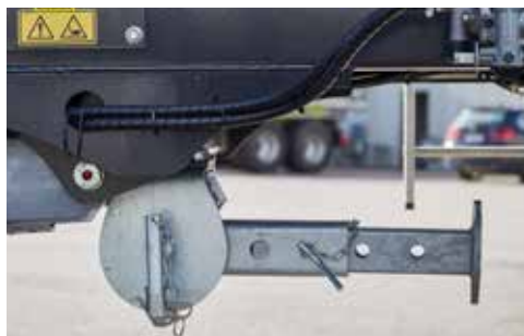
Béquille mécanique réglable au milieu et rabattable en arrière pour une meilleure stabilité
