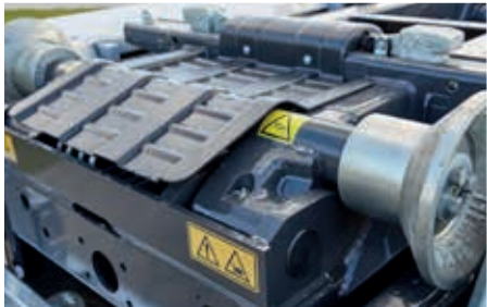
De grands rouleaux en acier coulé (ø 310 mm) à larges bords de centrage facilitent la mise en place du conteneur.
