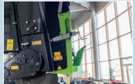
Chaîne cinématique des hérissons horizontaux. Limiteur de charge par embrayage à came dans l'arbre de transmission au tracteur.
