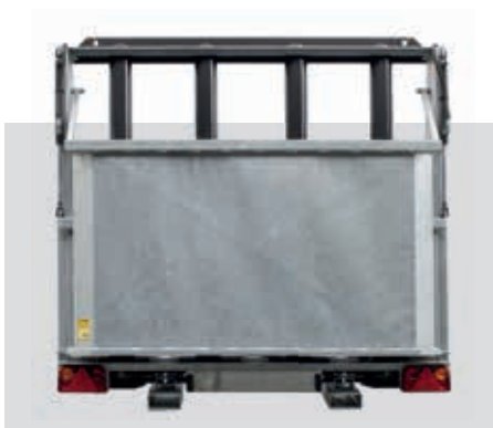
En option : protection de rouleaux d'épandage et coulisseau de stockage pour ADS 60
