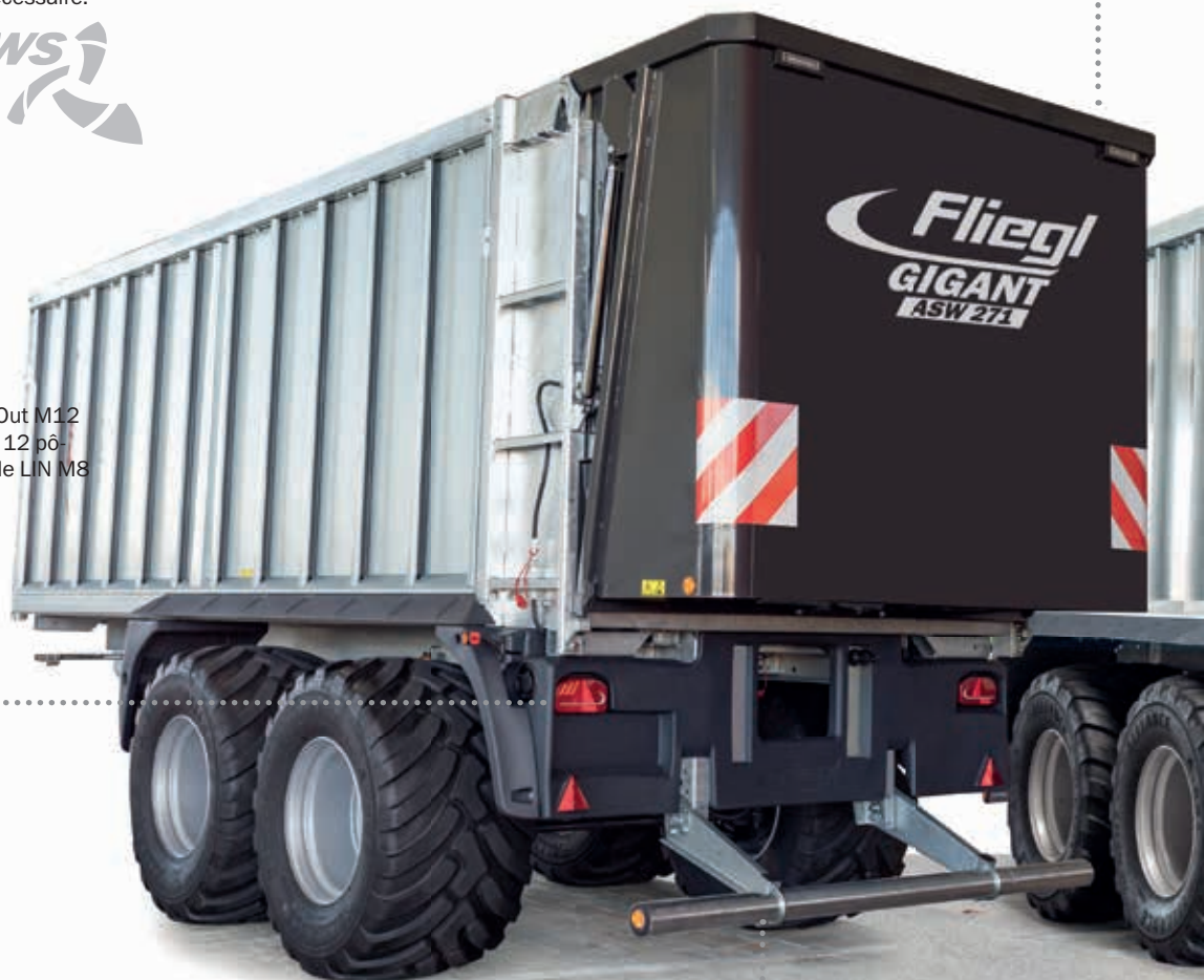
Feux de signalisation arrière Full LED „Dynamic“ avec Clignotant dynamique et matériaux résistant aux chocs
