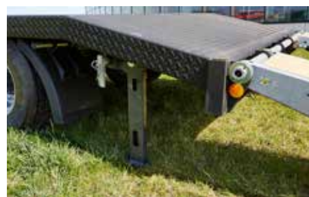
Appui arrière avec 2 béquilles de sécurité
