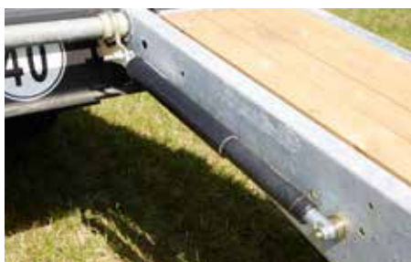
Rampes d'accès avec levier à ressort de série, ou système hydraulique en option
