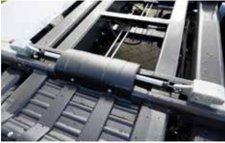
Système de verrouillage commutable pour verrouillage intérieur et extérieur
