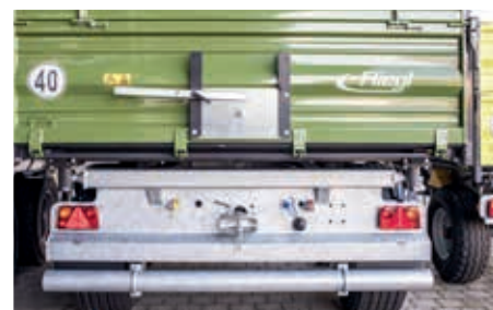
Version 40 km/h avec protection anti-encastrement et garde-boue
