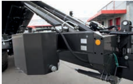
Système hydraulique embarqué 60 L (90 L en option) entraîné par prise de force avec pompe hydraulique et cuve à huile
