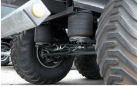
En option : suspension pneumatique avec basculement automatique
