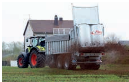
Épandeur « Profi V2 » avec paroi arrière pour épandage large fermée
