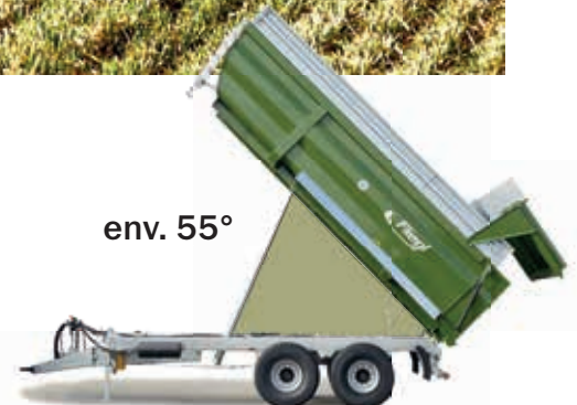
Benne tandem TMK 273 Profi d'une longueur de 6,80 m avec un angle de basculement d'env. 55°
