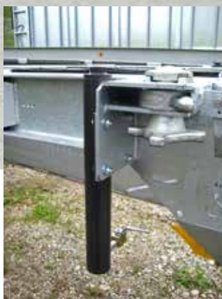
Cylindre pour dispositif de levage hydraulique
