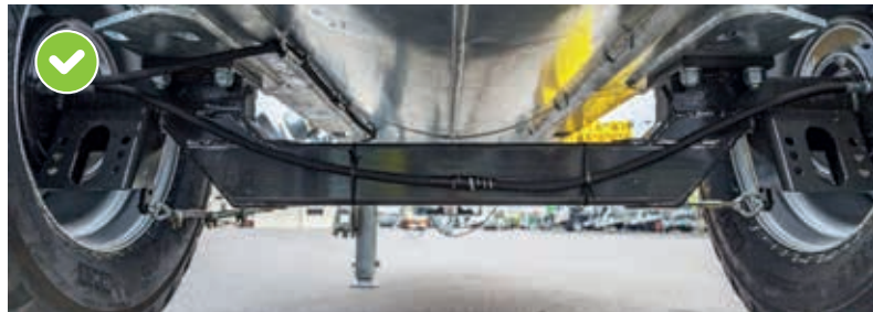
Nedbygget aksel ved 5000 – 8600 liter Lavt tyngdepunkt sørger for optimale kjøreforhold i skråninger
