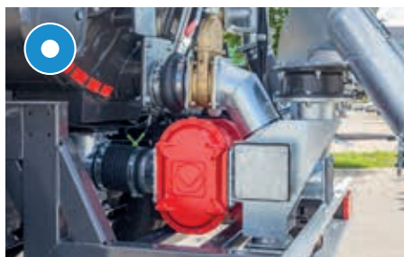
Kraftig pumpe med roterende stempel fra Vogelsang VX 186-260 Q med ettersuge- funksjon for å suge gjødselslangen tom etter fullmelding
