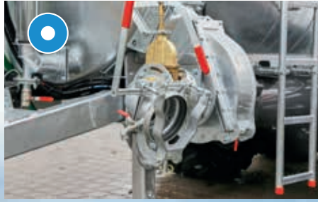
Kun ved vakuumtank: turbofyller med hurtigkobler monterert på siden
