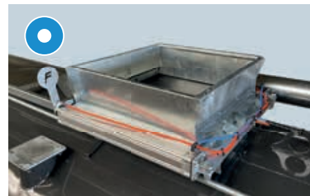
Pneumatisk skyvedeksel for ekstern fylling ovenfra
