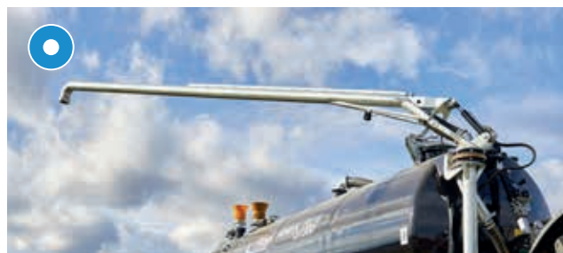
Overføringsarm 6" / lengde: 6 m
