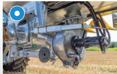
Ved vakuumbank: turbofyller midt under tanken – for suging på begge sider
