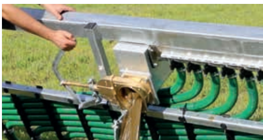
Oppsamlingsrom for fremmedlegemer, hydraulisk eller mekanisk tømning
