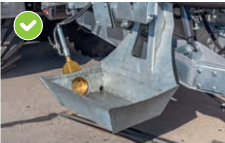
Oppsamler for sugeutligger Transfill med automatisk tømming på åkeren
