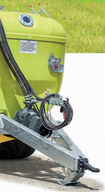
Sentrifugalpumpe Elba fra Battioni 3500 eller 6500 l/ min.
