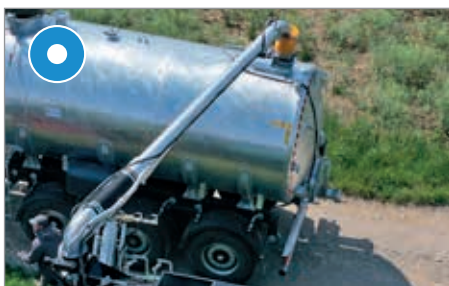
Kun for pumpetanker: sugearm 8", lengde 5 m
