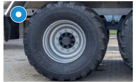
Dekk inntil maks. 26,5" mulig
