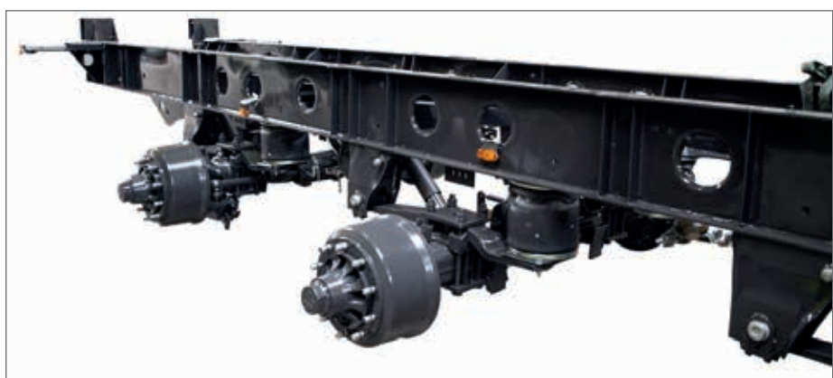
Spesiell rammekonstruksjon av finkornstål
