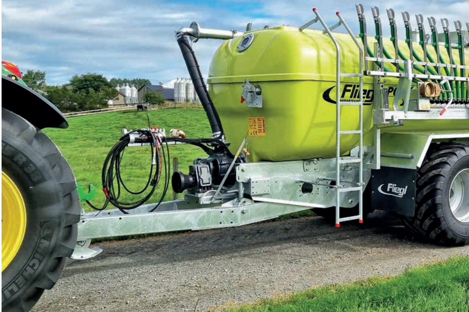
PFW Poly Line 9000 Enakslet Kraftig pumpe med roterende stempel
