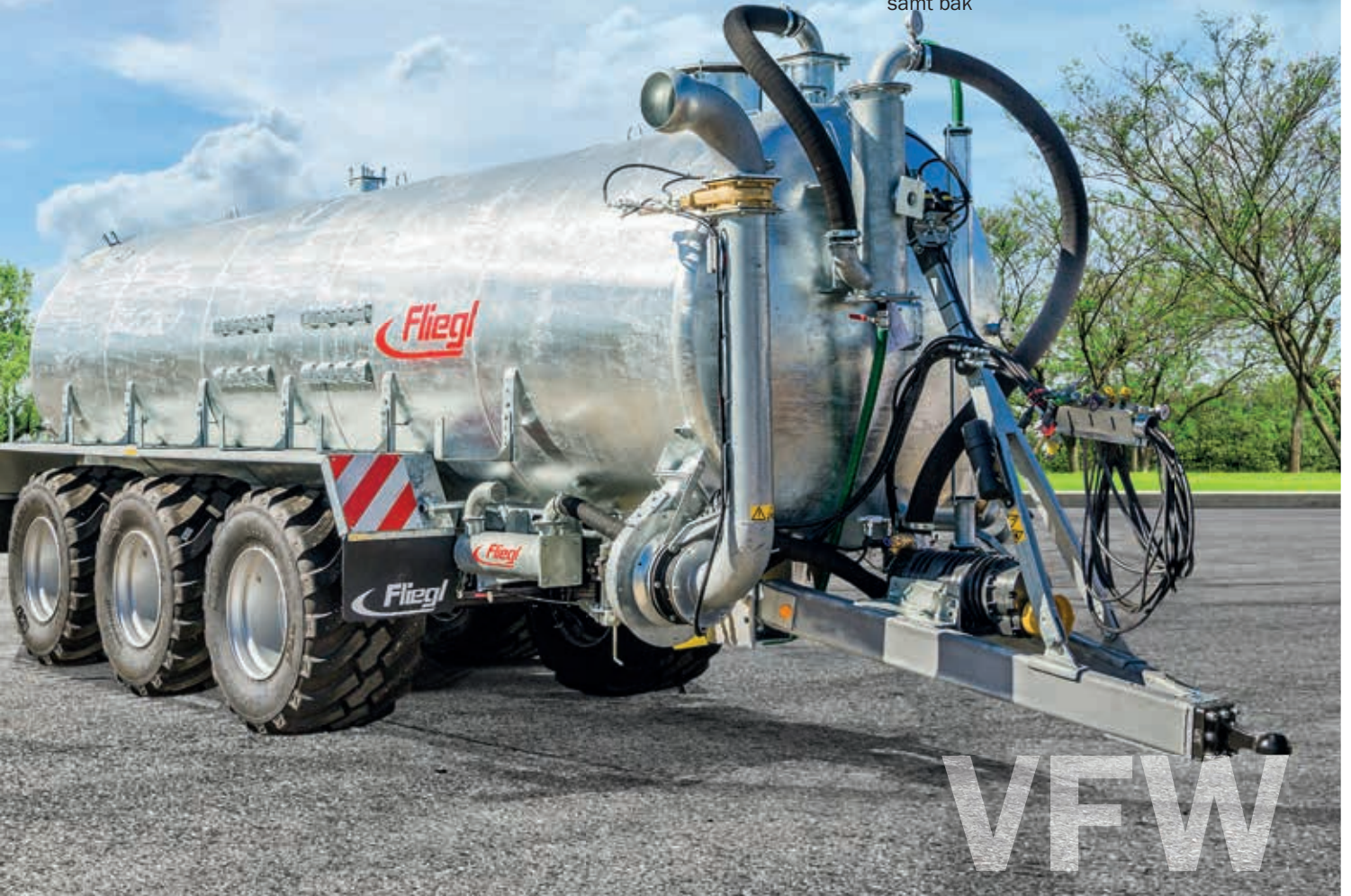
Kun ved vakuumtank: turbofyller med hurtigkobler monterert på siden
