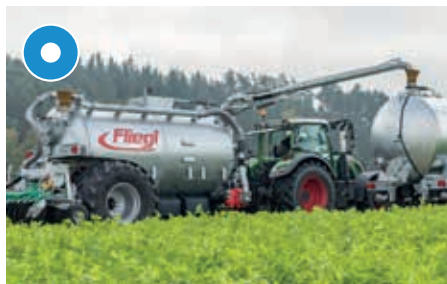
Sugearm kan svinges hydraulisk 8°
