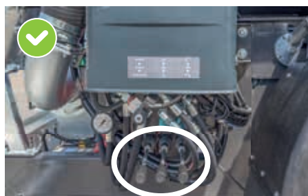
Styring via ekstern betjening (kun i kombinasjon med pumpe med roterende stempel)
