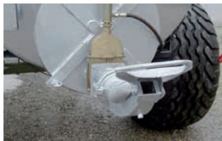
Kombispreder – kan klappes opp og ned
