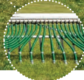
Jevn sprederkvalitet på grunn av korte utløpsslanger
