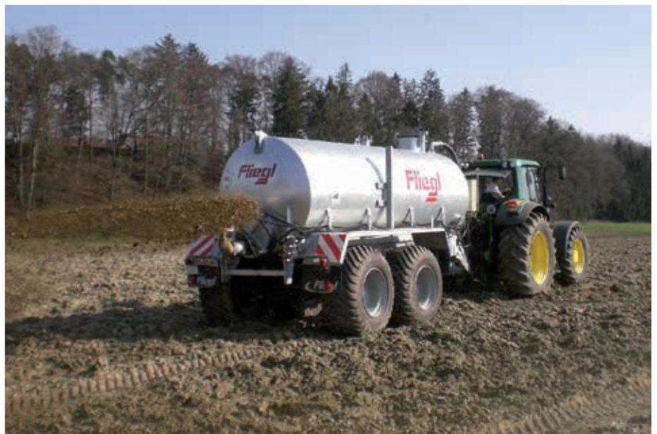
Pendelspreder for spredning i store dråper
