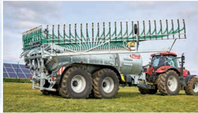
Den spesielle klappmekanismen sørger for at utløpsslengene ikke kommer i knekk
