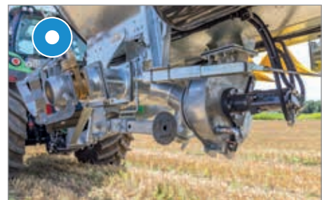
Ved vakuumentank: turbofyller midt under tanken – for suging på begge sider
