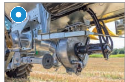
Ved vakuamtank: turbofyller midt under tanken – for suging på begge sider
