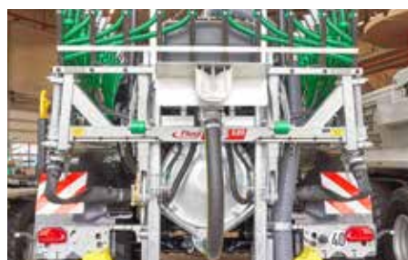
Ekstra spredningsmulighet med montert støthodespreder
