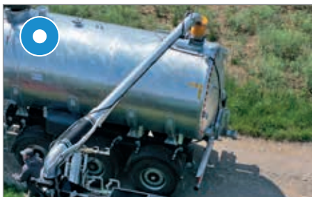
Kun for pumpetanker: sugearm 8", lengde 5 m
