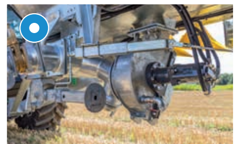
Ved vakuums tank: turbofyller midt under tanken – for suging på begge sider
