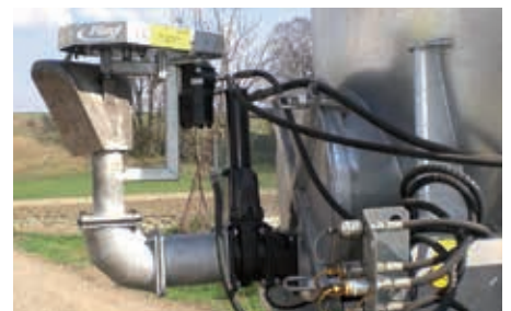
Hydraulisk pendelspreder med en arbeidsbredde på 12 til 18 m.
