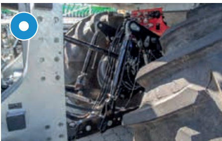
Trepunktshydraulikk føres med ved styring av akselen
