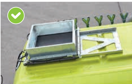
Skyvedeksel for ekstern fylling
