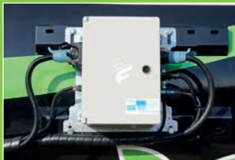
Koblingskap FFC med integrert jobbdatabas og ISOBUS-grensesnitt
