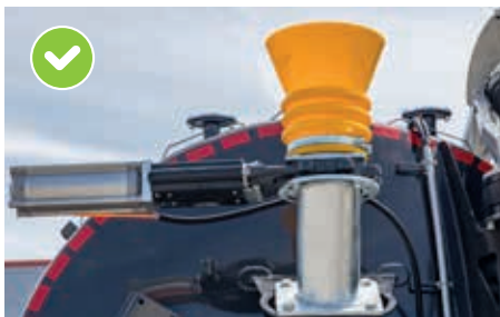
Dokktrakt oppe bak på tanken
