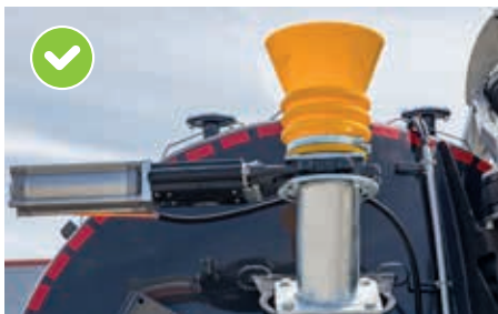
Aandoktrechter achter boven aan de tank
