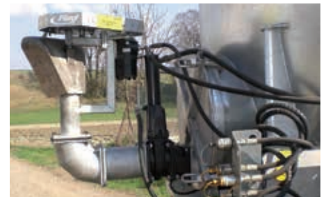
Hydraulische pendelasverspreider met een werkbreedte van 12 tot 18 m.
