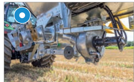
Bij vacuümtank: Turbovuller midden onder de tank – voor aanzuigen van beide kanten
