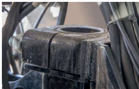
As centraal gepositioneerd, hydraulische besturing voor rit in hondenloop
