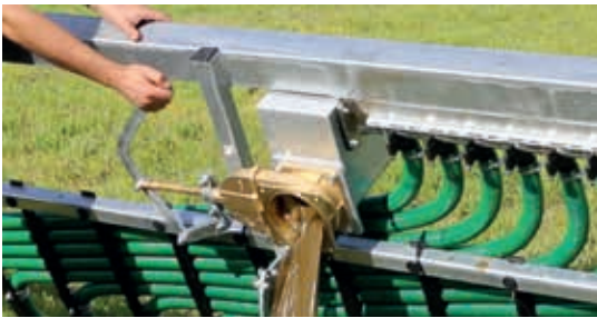
Ophopingskast voor vreemde voorwerpen, mechanische of hydraulische leging
