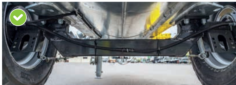
Gebogen as bij 5000 - 8.600 liter Lager zwaartepunt zorgt voor een optimaal rijgedrag op een helling
