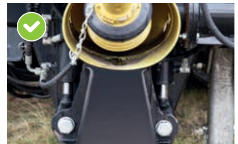
dissel is aan beide zijden geveerd
