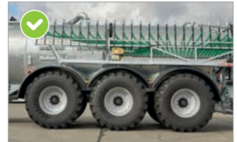
Spatbord voor één wiel in combinatie met hydr. vering
