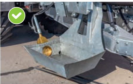
Opvangbak voor zuigarm Transfill met automatische leging op de akker
