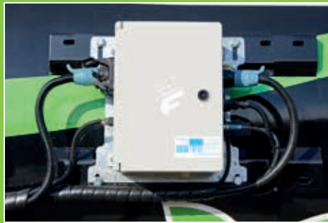
Schakelkast FFC met geïntegreerde jobcomputer en ISOBUS-interface
