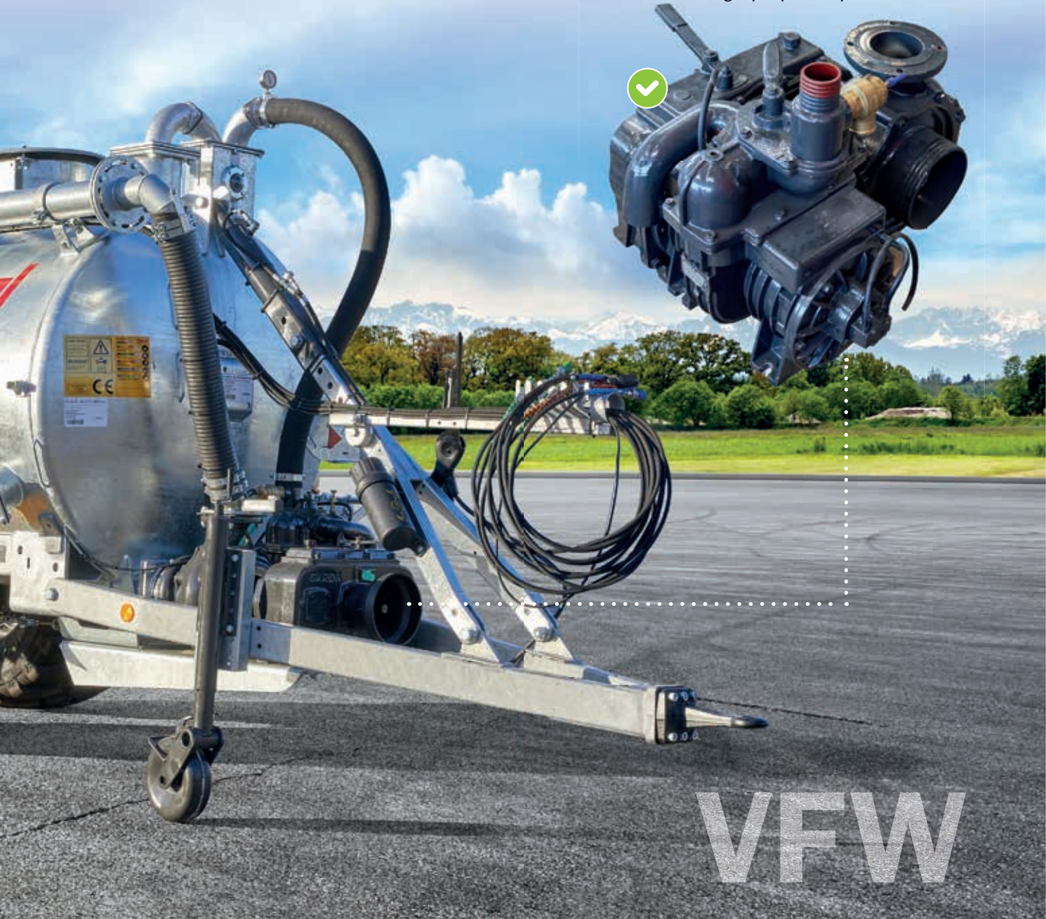
GARDA-pomp: Combinatie uit centri- fugaalpompe en compressor
