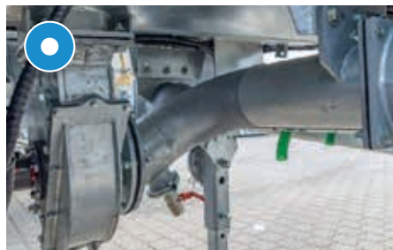
Hydraulische turbovuller, midden onder de tank
