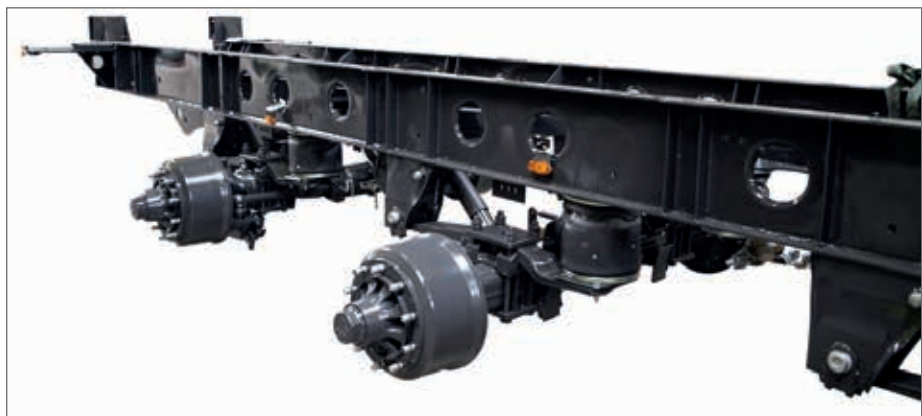
Speciale frameconstructie van fijnkorrelig staal
