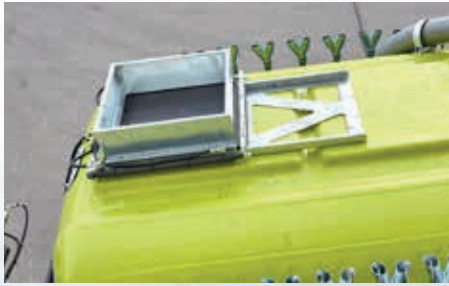
Schuifdeksel 600 x 600 mm pneumatisch of hydraulisch
