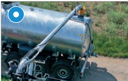
Alleen voor pomptanks: Afzuigarm 8", lengte 5 m
