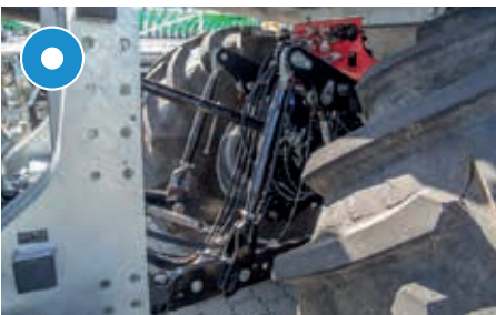
Driepuntshydrauliek wordt bij het sturen van de as meegevoerd
