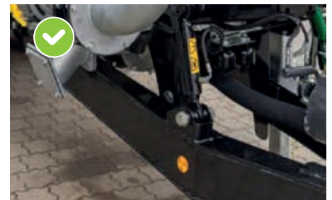
dissel is aan beide zijden geveerd
