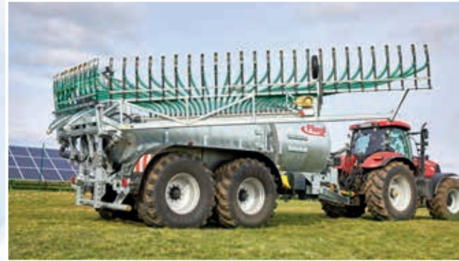
Geen geknikte uitlooslangen door speciaal opklapmechanisme
