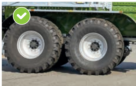
Wzmocnione wycięcie nadkola i ogumienie 750/60-R30,5"
