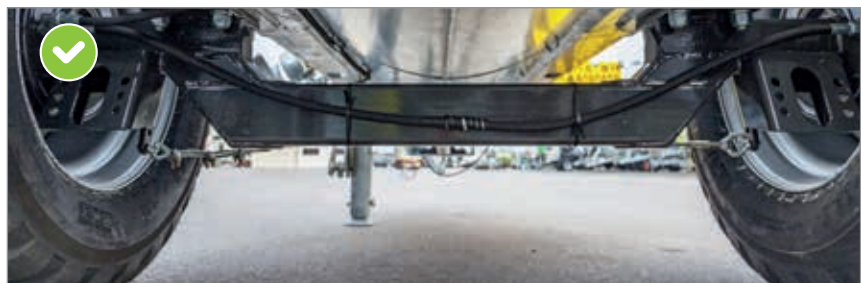
Oś jezdna, wygięta dla zbiorników 5000–8600 litrów Nisko położony środek ciężkości zapewnia optymalną jazdę na zbiegu
