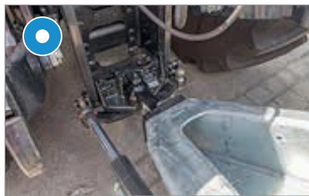
Wymuszony układ skrętu: mechaniczno-hydrauliczny lub elektroniczny
