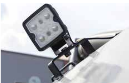
Reflektor roboczy do oświetlania aplikatora
