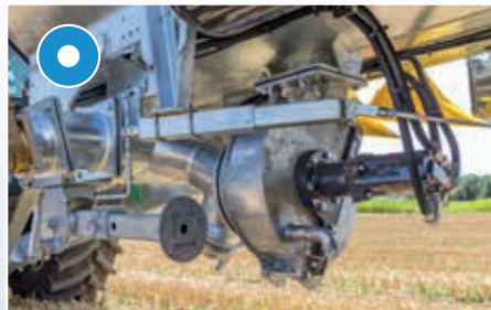
Dla VFW: Turbonapełniacz mocowany centralnie od spodu zbiornika - pozwala obustronnie napełniać zbiornik przez Turbo
