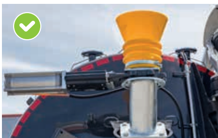
Górny kołnierz dokujący, z tyłu naczepy
