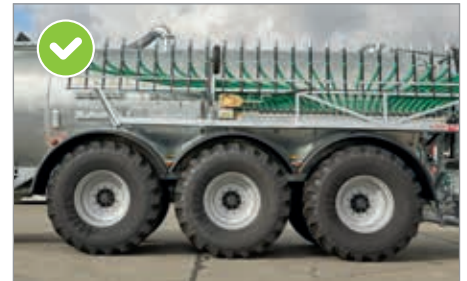
Pojedyńcze, wzmocnione wycięcia nadkola w połączeniu z zawieszeniem hydraulicznym
