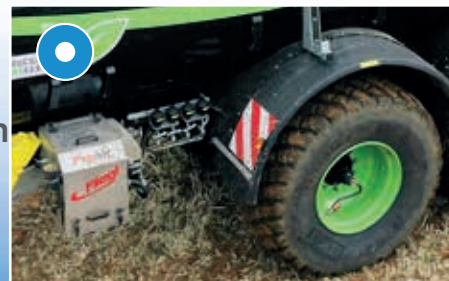
Układ regulacji ciśnienia w oponach
