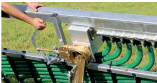
Skrzynka na wychwytywane ciała obce – opróżniana mechanicznie lub hydraulicznie
