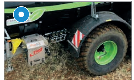
Układ regulacji ciśnienia w oponach
