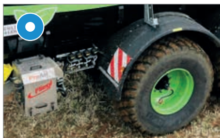
Układ regulacji ciśnienia w oponach
