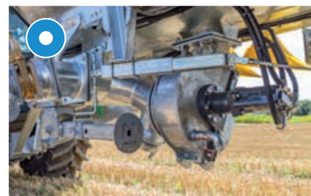
Dla VFW: Turbonapełniacz mocowany centralnie od spodu zbiornika - pozwala obustronnie napełniać zbiornik przez Turbo
