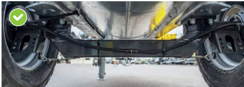
Oś jezdna, wygięta dla zbiorników 5000–8600 litrów Nisko położony środek ciężkości zapewnia optymalną jazdę na zbiegu
