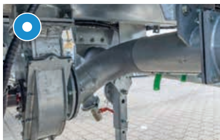
Turbonapętniacz mocowany centralnie, od spodu zbiornika
