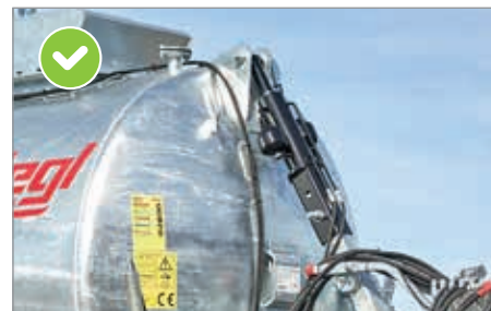
Dyszel amortyzowany hydraulicznie
