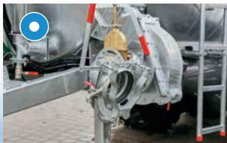
Tylko dla VFW: Turbonapełniacz boczny z szybkosprężem i zaworem ręcznym
