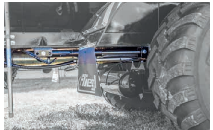
Agregat jezdny regulowany (bezstopniowo) hydraulicznie
