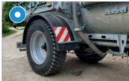
Ogumienie do aplikowania w rozstawie kukurydzy
