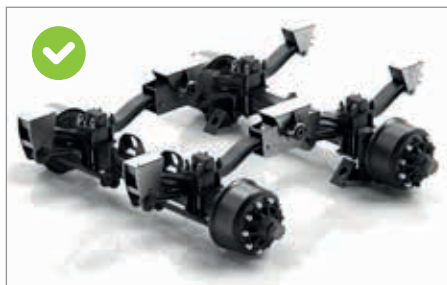
Zawieszenie paraboliczne GIGANT PLUS dla MAXX Line Plus o pojemnościach 16 000 - 20 000 l
