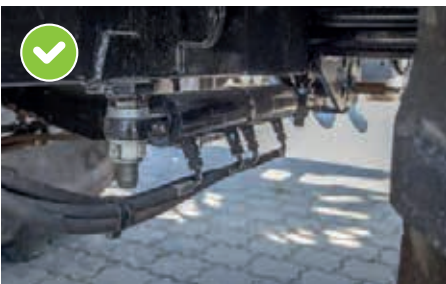
Oś łożyskowana centralnie z hydraulicznym układem skrętu do jazdy „psim chodem”
