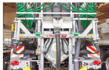
Rozlewacz zagięty „Prallkopf” zintegrowany trójnikiem z aplikatorem
