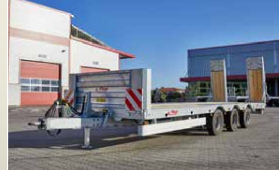
TPA 370 Oldalfal alapkitelben 800 mm Feljárórámpa felhajtható
