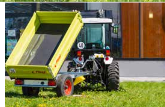
Egytengelyes három oldalra billentő pótkocsi, minden vontatómagasságra passzol
