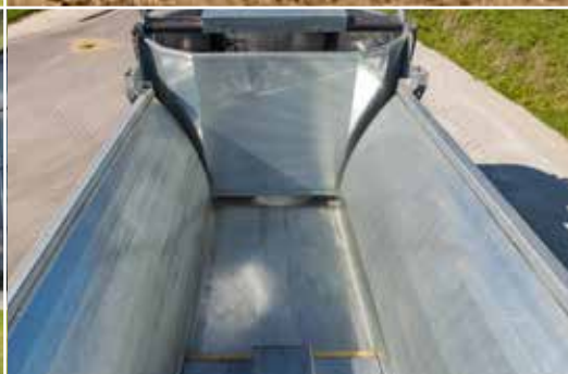
A hidraulikus letolórendszernek köszönhetően kisebb kopás - nem láncos lehordó
