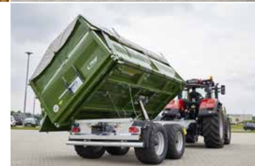
Tandem három oldalra billentő teknős pótkocsi Rendkívül robusztus az erősített oldalfalaknak köszönhetően
