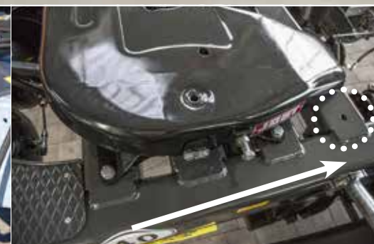
Mechanikus nyeregszerkezet eltolás egytengelyes és tandem Dollynál
