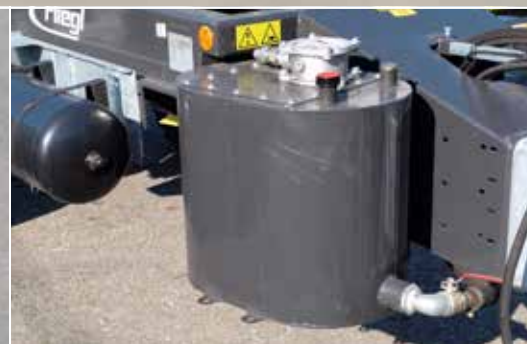
Fedélzeti hidraulika kardánhajtású hidraulika szivattyúval
