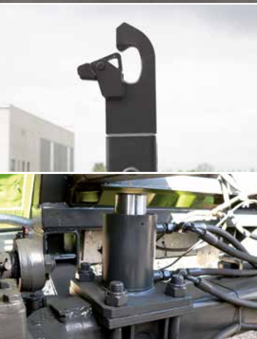
Opcionális: hidraulikus támasztás a tengelynél
