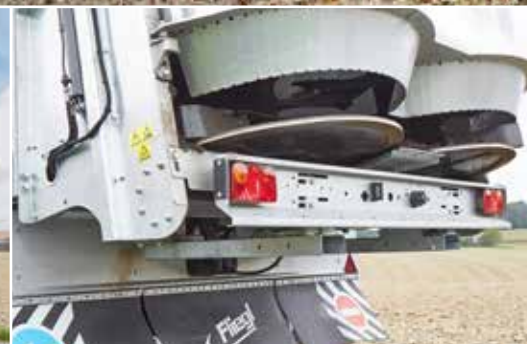
»Profi V2« szórószerkezet kidobólappáttal:
