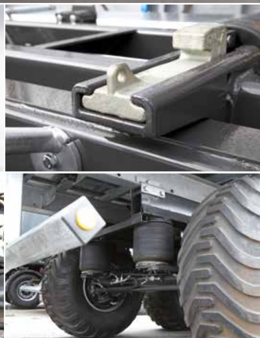
Opcionális: automata légrugózás süllyesztés billentéskor
