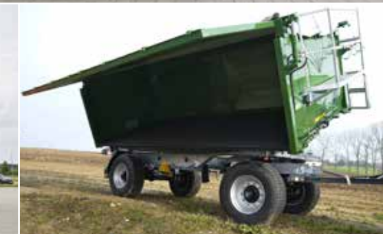
ZDMK 200 Profi Hidraulikus oldalfalnyitással
