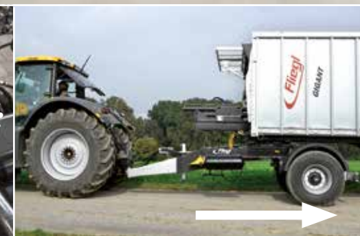
Hidraulikus nyeregszerkezet állítás egytengelyes és tandem Dolly esetén
