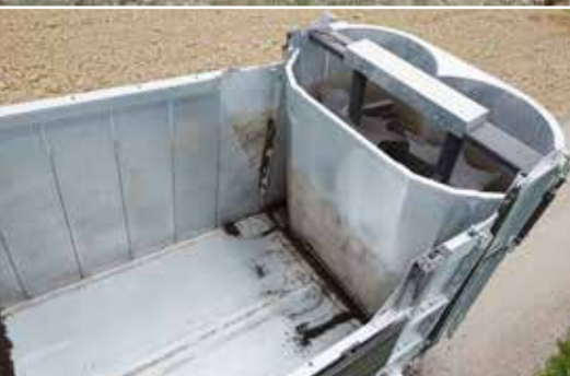
A teljesen horganyzott zsilip sorozatkivitelben felszerelve
