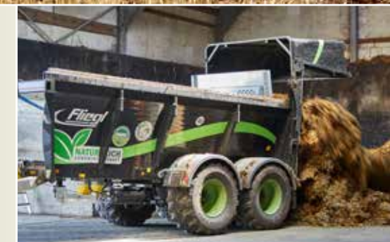
Az ADS opcionálisan 800 mm-es nagy rakodótér hátfallal felszerelhető és szállító pótkocsiként használható
