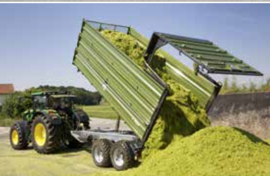
Silószállításához billentős pótkocsi hidraulikus hátfallal
