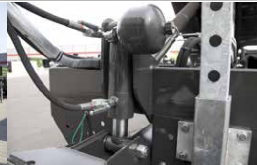
Hidraulikus vonórúd rugózás
