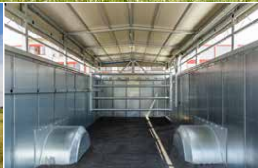
Állítható elválasztó rács és bordás acéllemez borítás kifolyónylással
