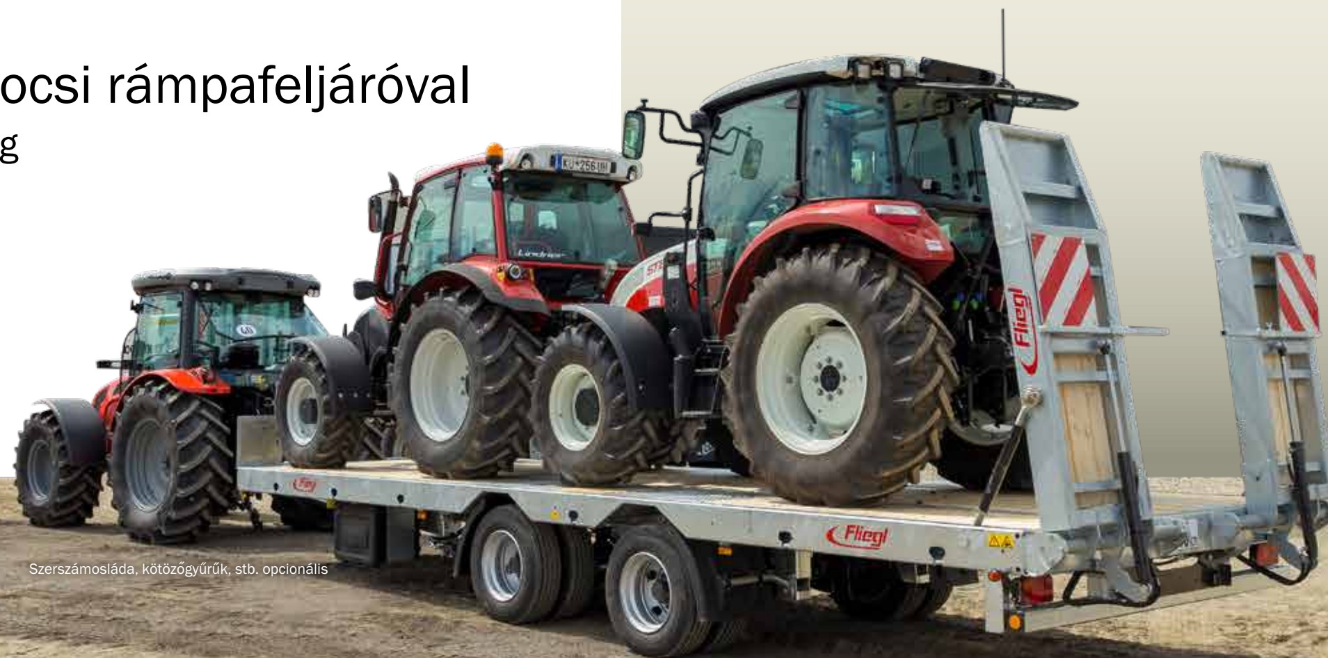
TPA 370 Oldalfal alapkitelben 800 mm Feljárórámpa felhajtható
