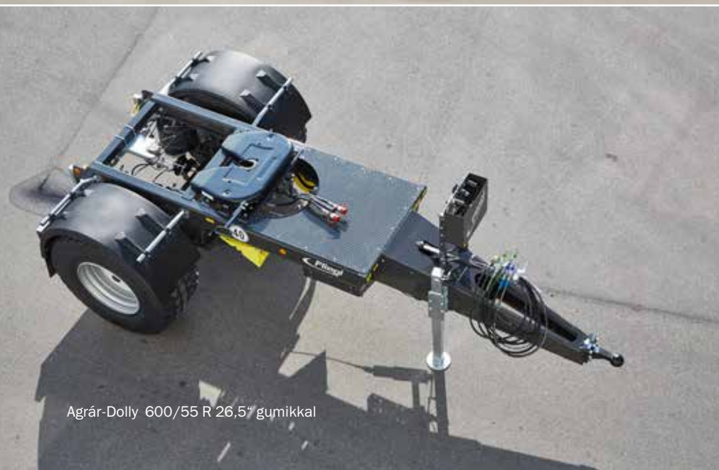
Fedélzeti hidraulika kardánhajtású hidraulika szivattyúval
