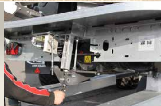
Az automatikus letolásszabályozással a letolási sebesség magától beállításra kerül
