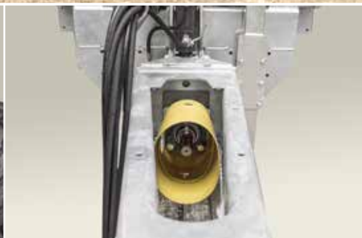
Kardánhajtás az adapterek meghajtásához
