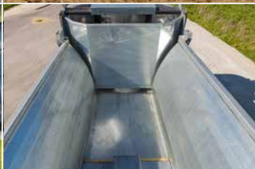
Systemet har minimal slitage hvis man sammenligner det hydrauliske afskubbesystem med bundkæder.
