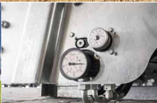
Mekanisk styring af afskubning via mekanisk potentiometer
