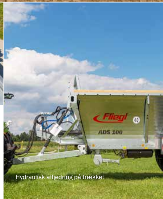
Systemet har minimal slitage hvis man sammenligner det hydrauliske afskubbesystem med bundkæder.
