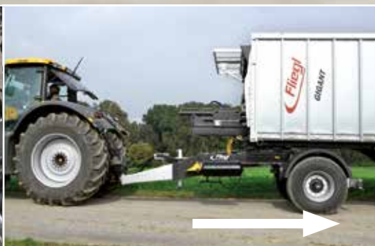
Hydraulisk flytning af koblingspunktet med 1 og 2 akslet dolly
