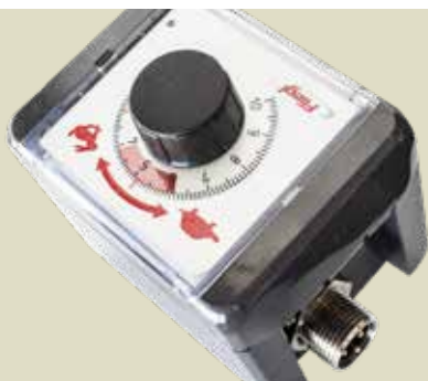
Elektrisches Potentiometer mit einstellbarer Vorschubgeschwindigkeit am Bedienpult
