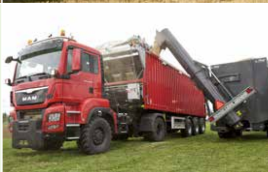
Ovenfor: Overlæssesnegl ULS 400 til korn Overlæssekapacitet ca. 7,5 t/min
