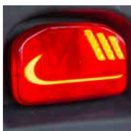
Voll-LED Rückleuchte „Dynamic“ mit dynamischer Blinkfunktion aus schlagfestem Material
