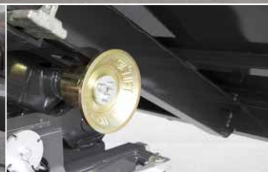
Store ruller af stålstøbegods (Ø 310mm) med centreret hældning letter løftning af containeren.
